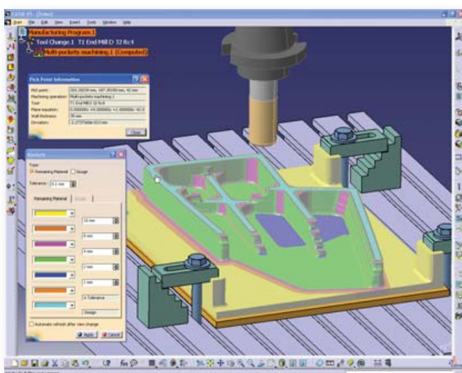
Rys 4. Analiza naddatków po symulacji usuwania materiału
